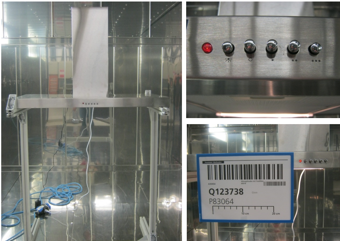
Bilder 2 – 4 : Abzugshaube mit Einstellungen in der Prüfkammer
